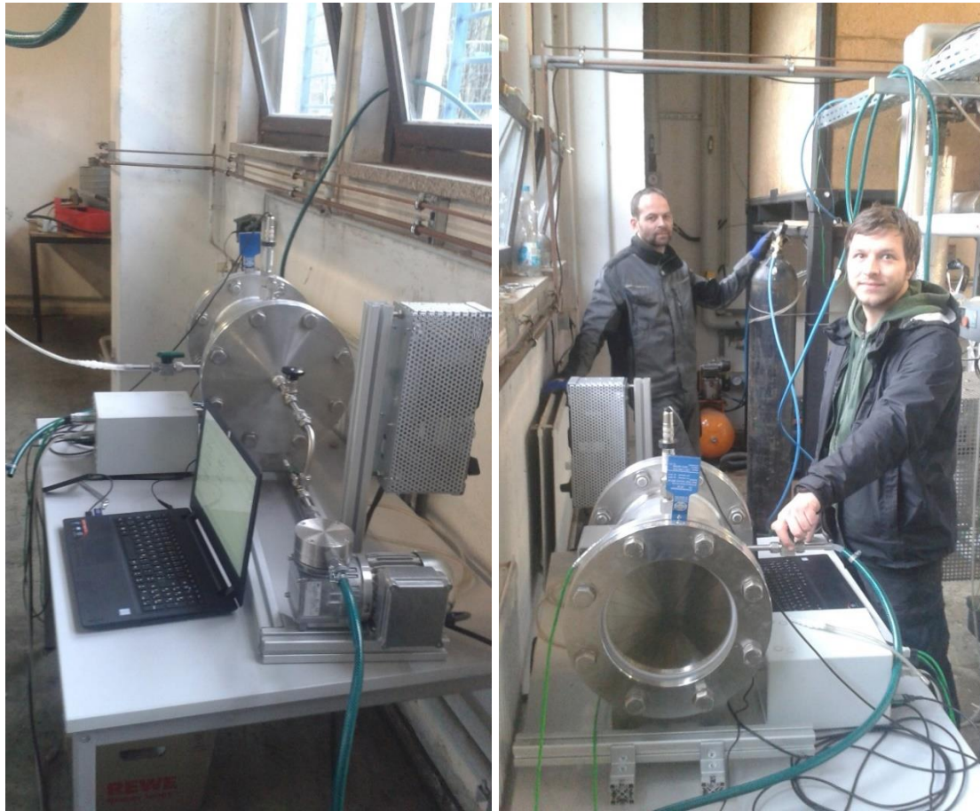
Abbildung 1-42: Links: An Biomasse-Vergasungsanlage gekoppelter Produktgasspeicher, Rechts: Spülen des Speichers mit Stickstoff aus einer Gasflasche
