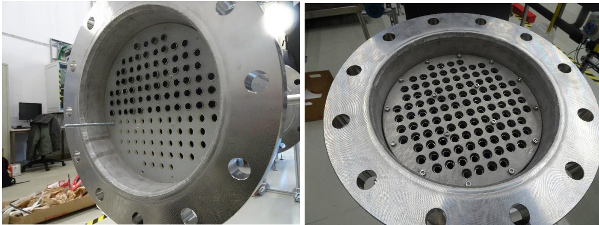
Abbildung 1-41: Links: Zur Hälfte berohrte Bündelaufhängung des RB-LWS (hf), Rechts: mit äußerer Lochscheibe gequetschte Bündelaufhängung
