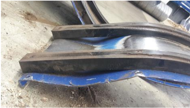
Abbildung 1-13: durch Zugwirkung der Kette verformtes Gehäuseteil
