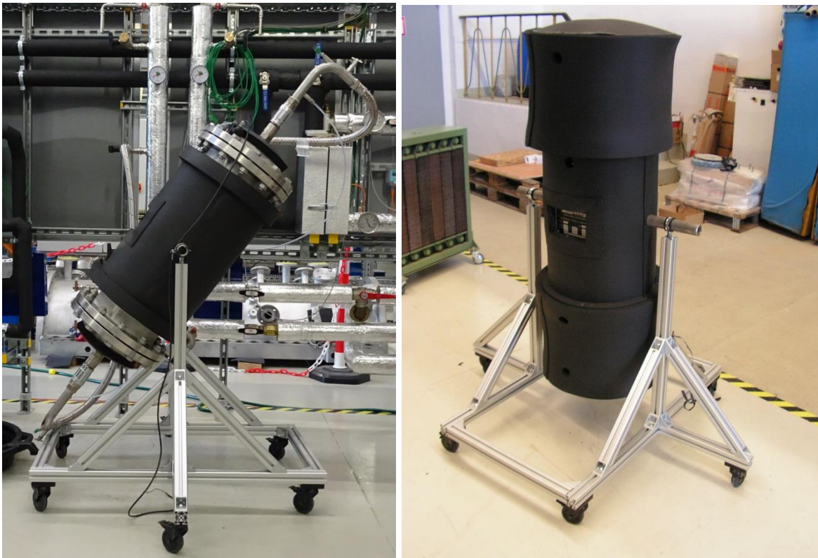
Abbildung 1-40: Links: Latentwärmespeicher (hf) im Zittauer Kraftwerkslabor während Druckprüfung, Rechts: - mit Iso.
