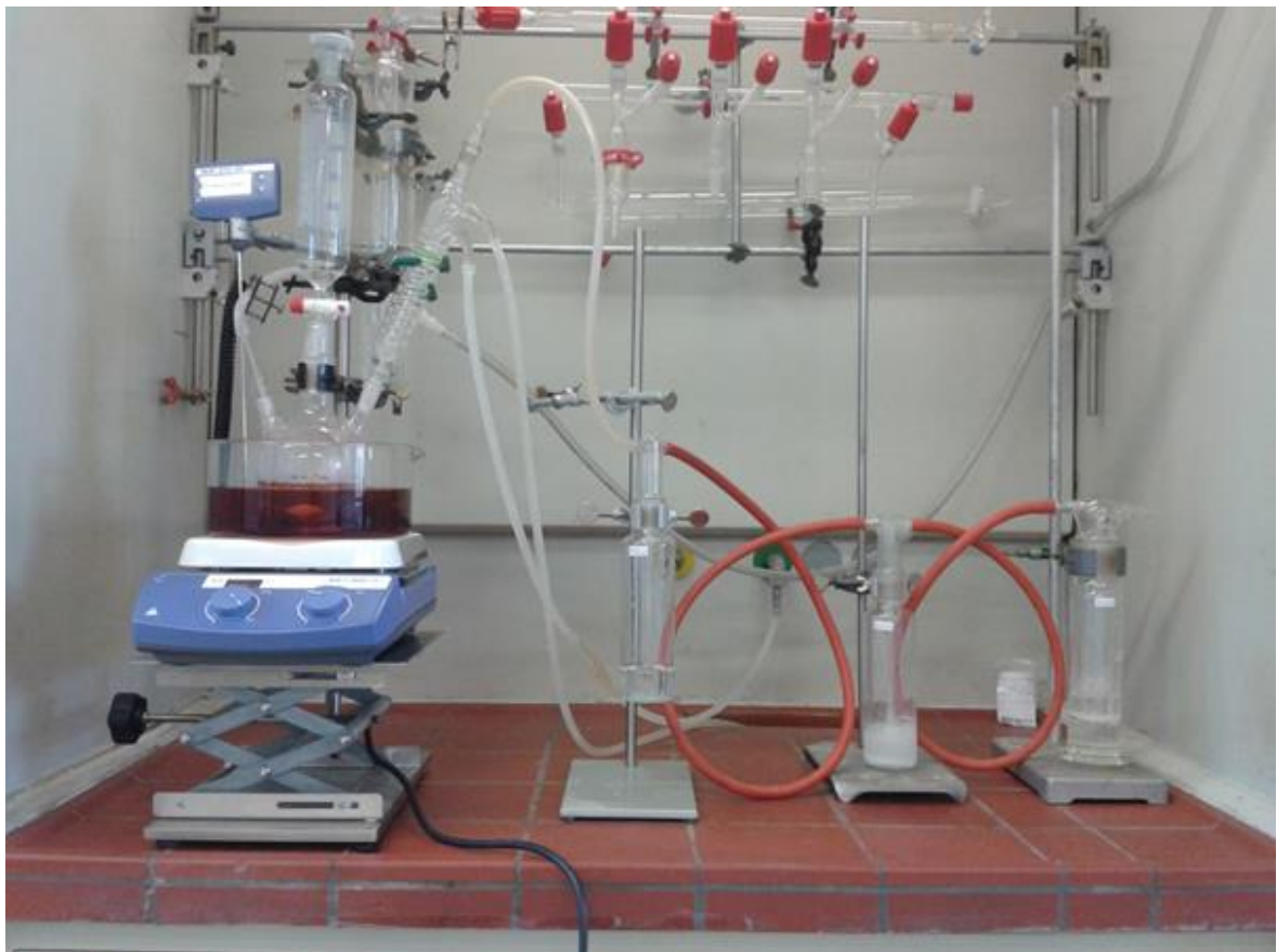
Abbildung 1-35: Apparatur zur Bestimmung des anorganischen Kohlenstoffgehaltes
