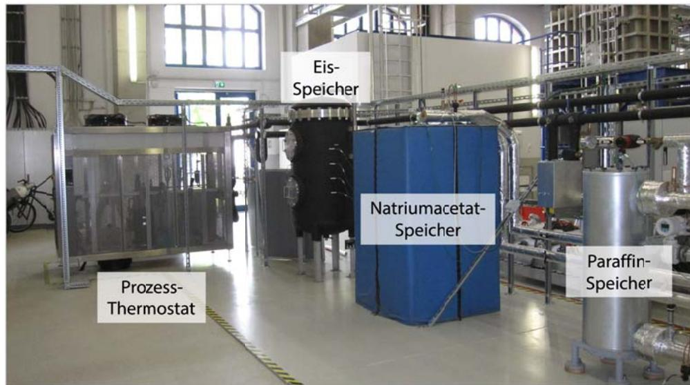
**Abbildung 3** Versuchsstand zur detaillierten Untersuchung von Kälte- und Wärmespeichern
