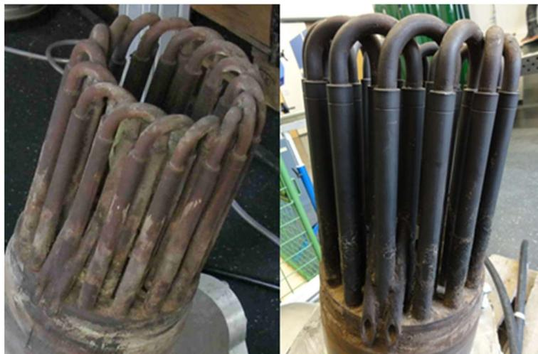
Abbildung 6: Erhitzerkopf des Stirlingmotors bevor (links) und nach (rechts) den Experimenten in der Wirbelschichtfeuerung [13].
