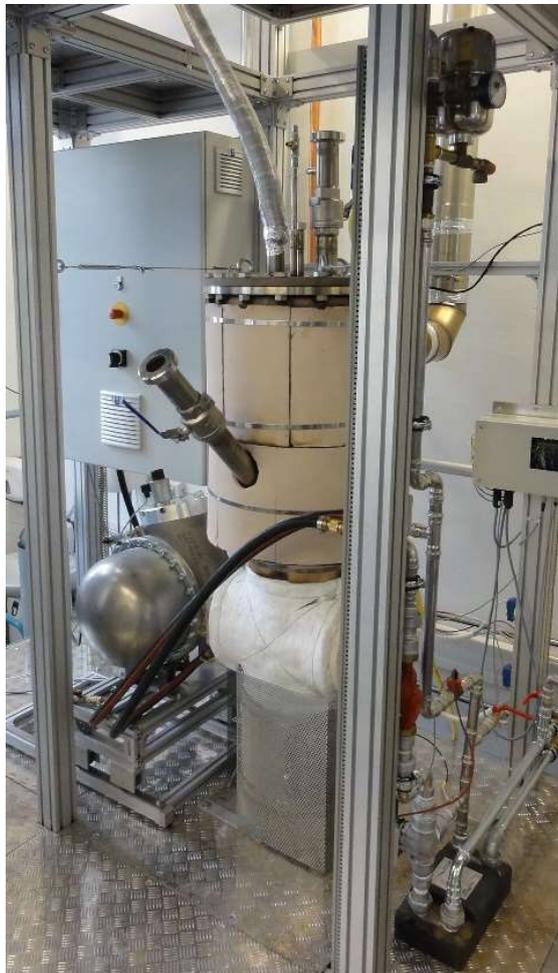
Abbildung 3: Experimenteller Aufbau der 100 kW Wirbelschichtfeuerung mit dem Erhitzerkopf eines Stirlingmotors als In-Bett-Wärmeübertrager [13].
