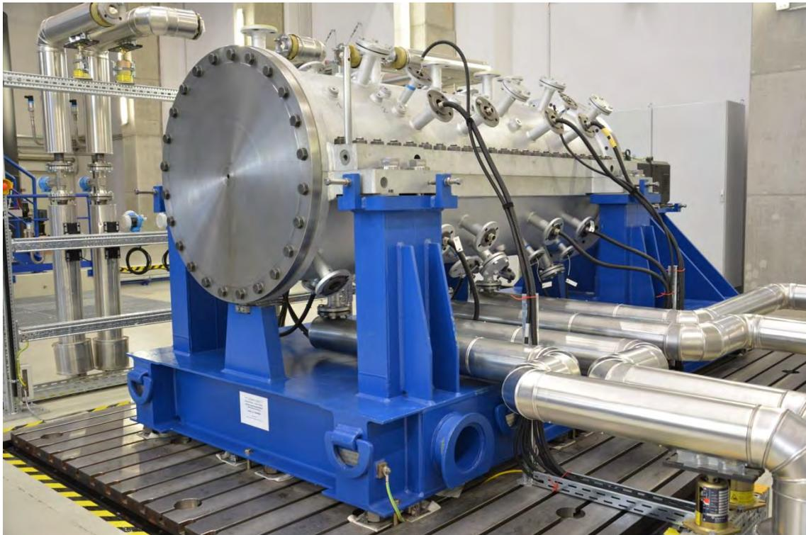
Abb. 4-20: Magnet- und Fanglagerprüfstand MFLP im Zittauer Kraftwerkslabor
