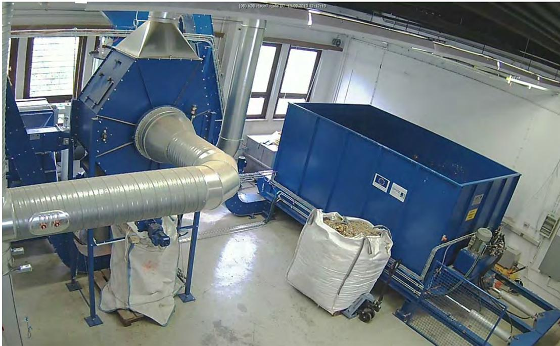
Abb. 4-27: Trocknungsanlage für Holzhackschnittzel
