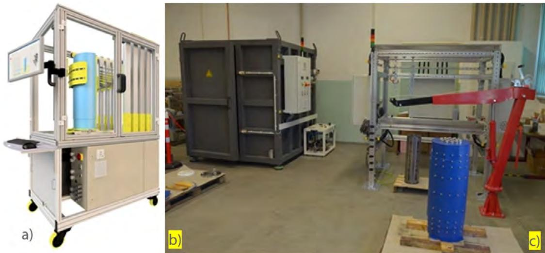
Abb. 4-1: Illustration der konzipierten Versuchsstände: a) Versuchsanlage „Gammastrahlung“, b) Versuchsanlage „Schallemissionsanalyse“, c) Versuchsanlage „Temperaturfeld“ und „Schwingungsanalyse“
