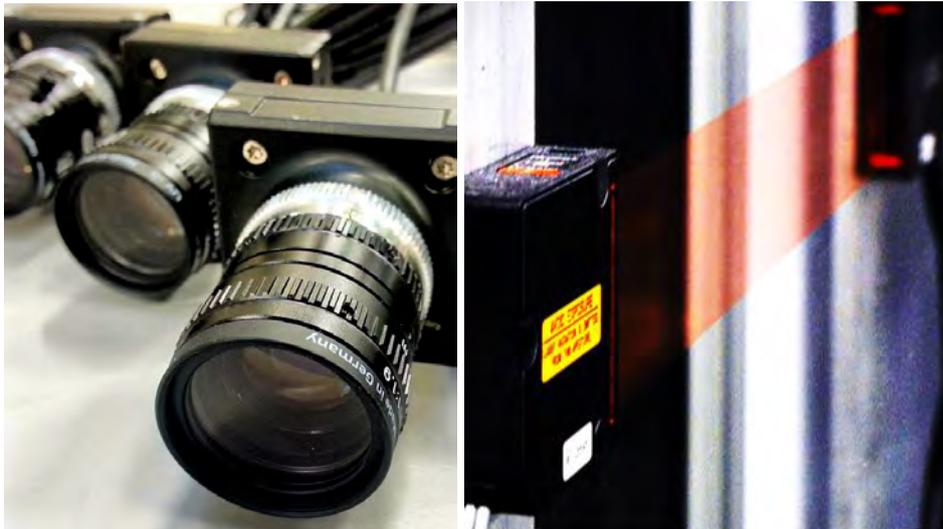
Abb. 4-14: Kompaktes Mehrkameranensystem für den Einsatz in Forschung und Industrie (links), Lasersensoren für Trübungs- und Objektmessungen (rechts)
