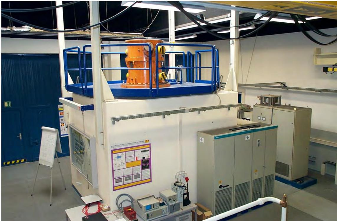
Abb. 4-21: Magnet- und Fanglagerprüfstand FLP 500
