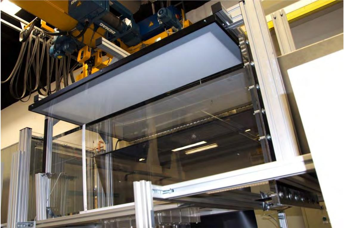
Abb. 4-9: Der Plexiglas-Strömungskanal des Versuchsstands DVABEG
