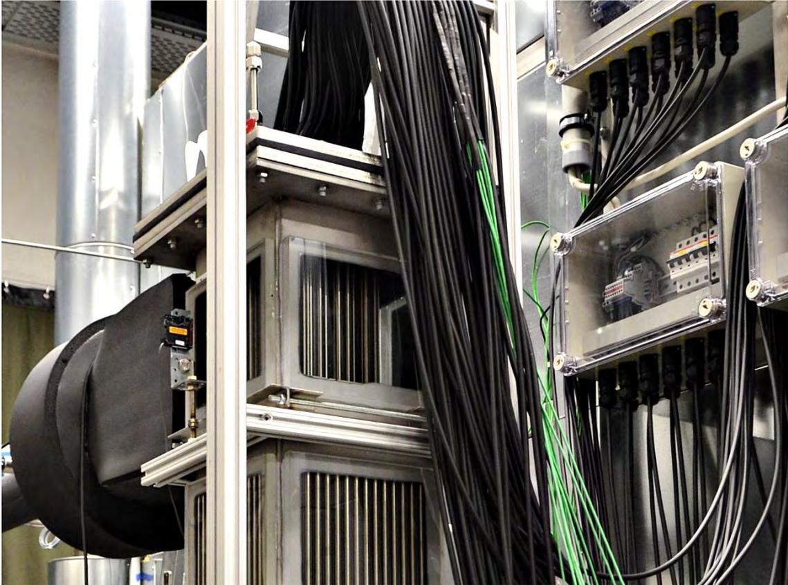
Abb. 4-11: *Beheizbarer Brennelemente-Dummy*
