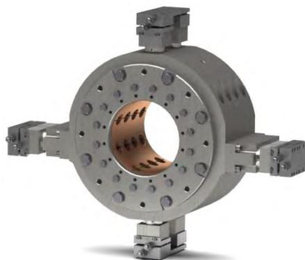
Abb. 4-16: Gleitfanglager für Untersuchungen am Versuchsstand MFLP
