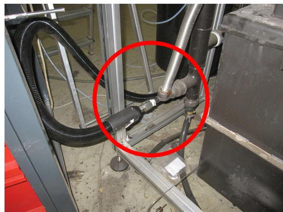
Abb. 5-5 Darstellung der Messstelle zur Erfassung des Produktgas-Wassergehaltes
