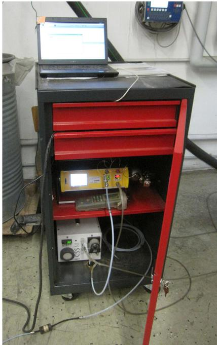
Abb. 5-1 Mikro-Gaschromatograph mit vorgeschaltetem Messgaskühler zur Erfassung der Produktgaszusammensetzung
