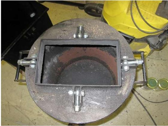
*Abb. 5-6 Nach der MF deinstallierter Filterstaubbehälter zur Abwägung und Probenahme des Filterstaubes*
