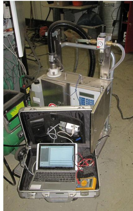
Abb. 5-2 Prallstrahlpsychrometer zur Erfassung der Wassergehaltes im Produktgas
