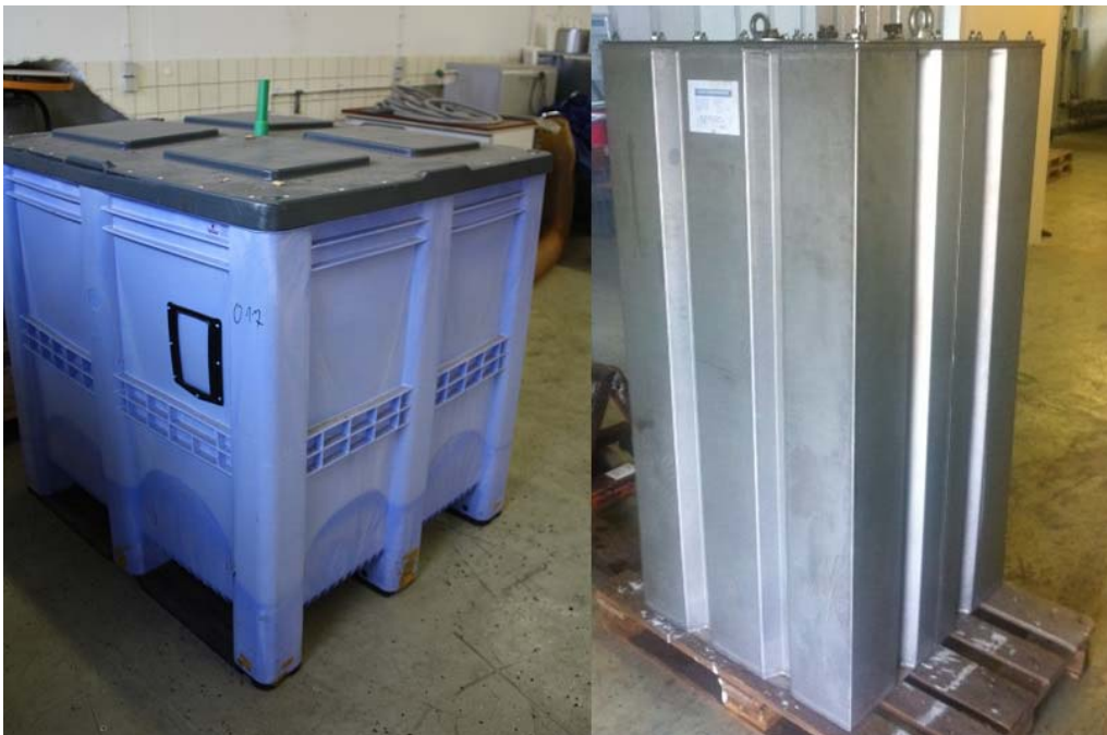
Abbildung 2-3: Paraffinspeicher (links), Natriumacetatspeicher (rechts) ohne Isolierung
