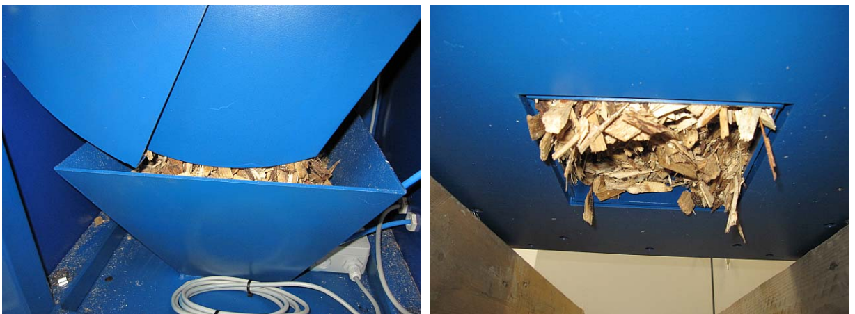
Abbildung 6-3: Verblockung Hackschnitzelwaage, rechteckiger Auswurftrichter
