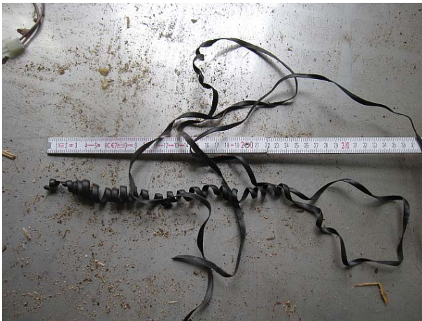
Abbildung 6-9: Kunststoffabrieb aus dem Kratzkettenförderer
