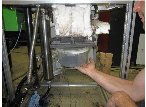
Abb. 5-8 Nach der MF Probenahme der Rostasche bei laufendem Rost
