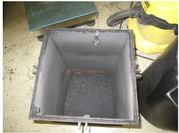
Abb. 5-7 Nach der MF deinstallierter Rostaschesammelbehälter zur Abwägung der Rostasche
