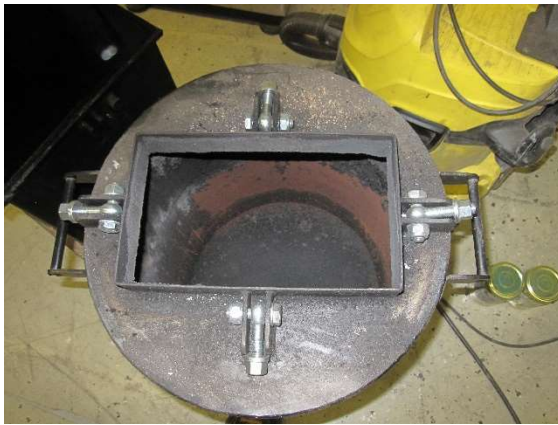
Abb. 5-6 Nach der MF deinstallierter Filterstaubbehälter zur Abwägung und Probenahme des Filterstaubes
