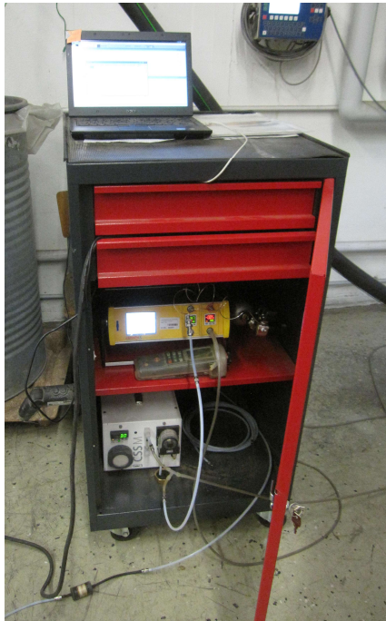
Abb. 5-1 Mikro-Gaschromatograph mit vorgeschaltetem Messgaskühler zur Erfassung der Produktgaszusammensetzung
