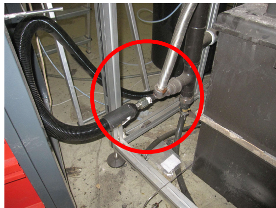
Abb. 5-5 Darstellung der Messstelle zur Erfassung des Produktgas-Wassergehaltes
