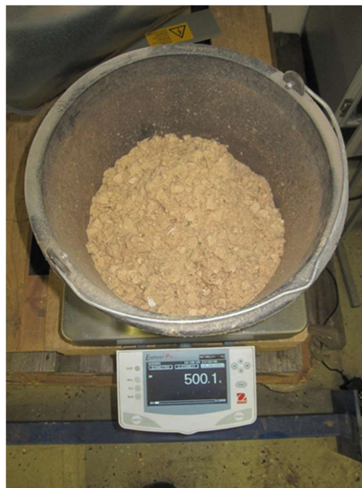
Abb. 3-3 Abwiegen des MDF-Materials vor der Zumischung
