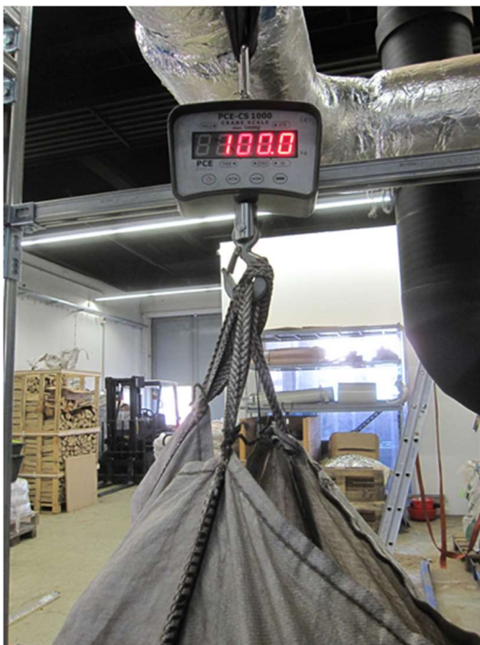
Abb. 3-5 Abwiegung der Gesamtmischung (100 kg) vor Zugabe in den Tagesbehälter
