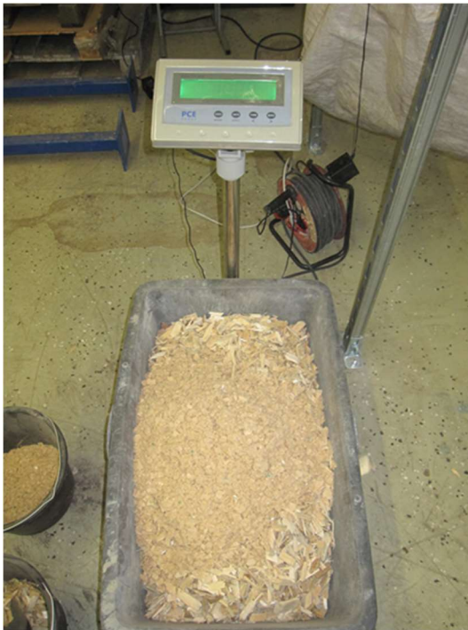
Abb. 3-4 Abwiegung der Gesamtmasse aus HHS und MDF vor der Vermischung (10 kg)
