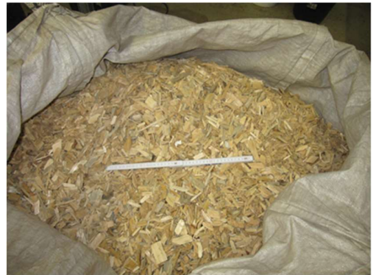
Abb. 3-6 Gesamtmischung aus HHS und MDF vor der Zugabe in den Tagesbehälter
