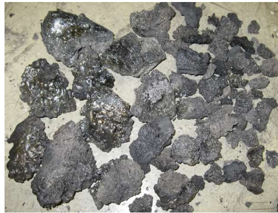
Abb. 8-18 Verschlackungsklumpen aus dem Reformer nach manueller Entfernung
