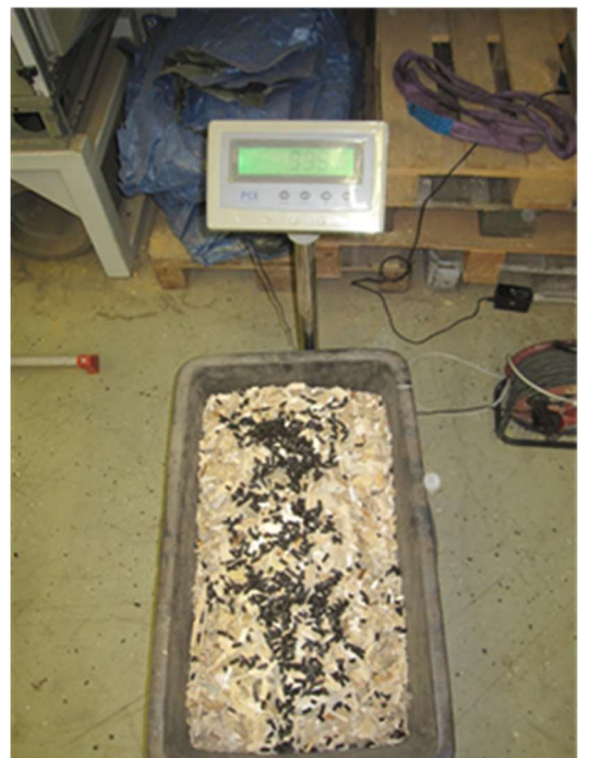
Abb. 3-7 Abwiegung der Gesamtmasse aus HHS und GR vor der Vermischung (10 kg)
