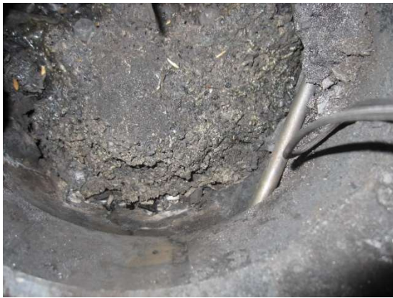
Abb. 8-17 Verschlackungsschicht in Höhe der Düsenhöhe im Reformer nach GR3
