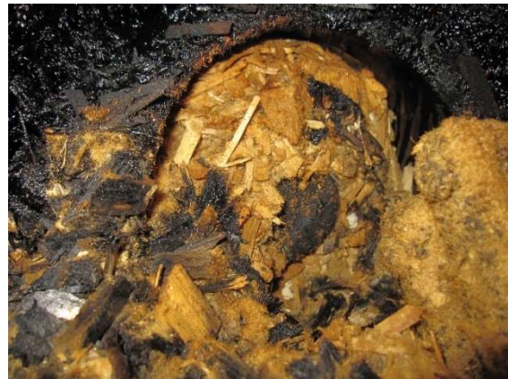
Abb. 8-6 Detailinnenansicht Reformer mit Brückenbildung durch hohen MDF-Anteil, MDF2
