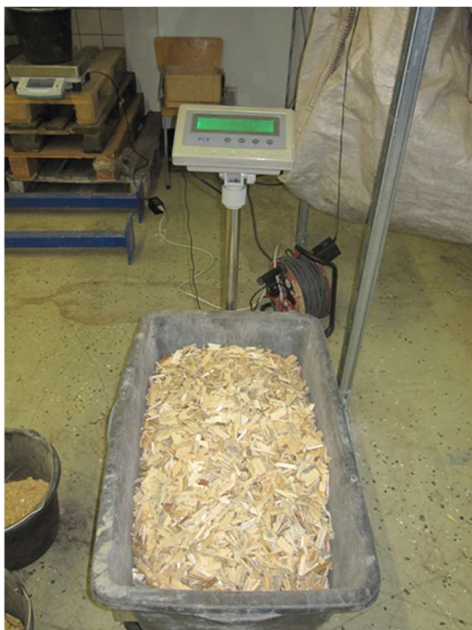
Abb. 3-2 Abwiegen der Standard-HHS vor MDF-Zumischung
