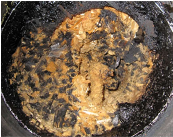
Abb. 8-10 Innenansicht Reformer nach MDF2
