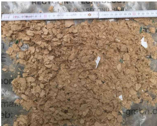
Abb. 2-1 zerleinerte Rückstände aus der MDF-Produktion
