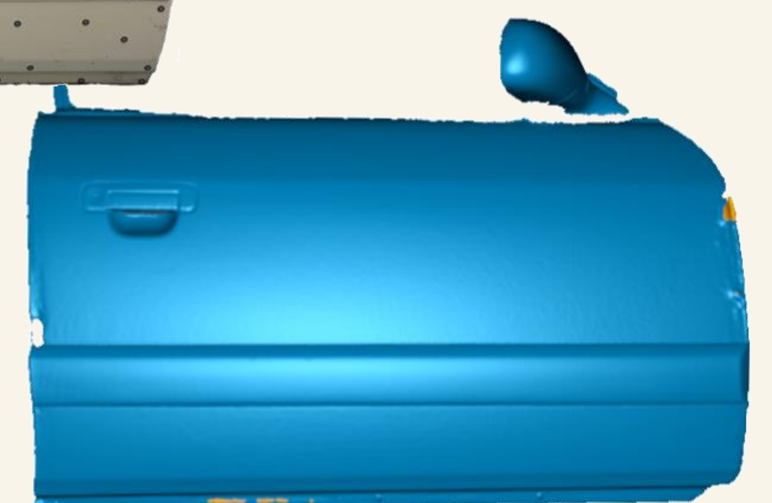
Optische 3D-Erfassung & digitale Rekonstruktion eines Bauteils
