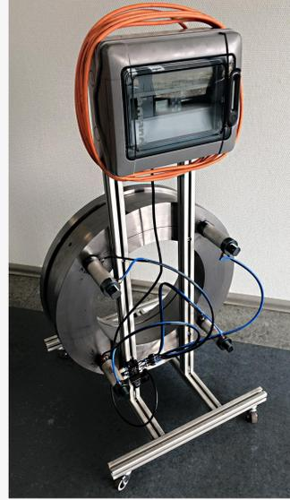
Teststand für Funktionstests der Dichtung
