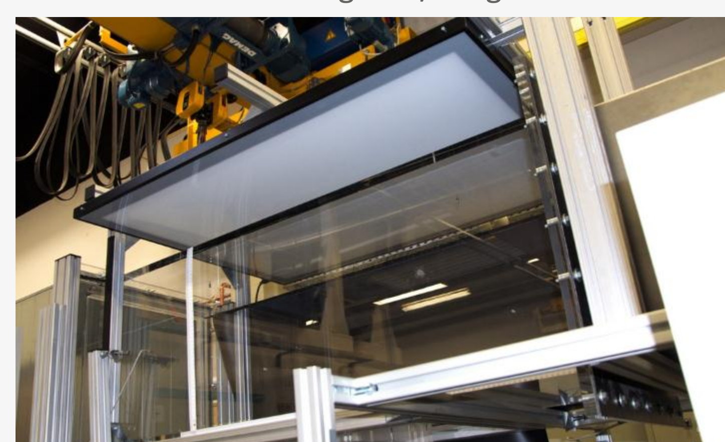
Horizontaler Plexiglas-Überströmungskanal (links), mit Kunstnebel sichtbar gemachte Luftströmung in Falschfarbendarstellung (rechts)
