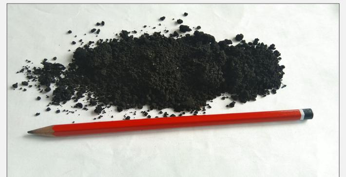
Abb. 1: bei Versuchsfahrten abgeschiedener fester Kohlenstoff
