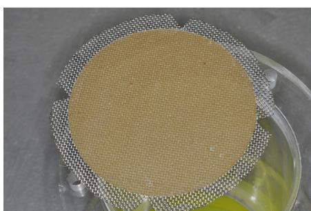
*Durch Filtration an der Rückhaltevorrichtung entstandener Filterkuchen
