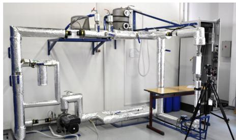
*Foto der Versuchsanlage „Unterkühltes Sieden“*
