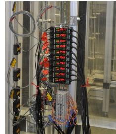
*Einsatz der Lasersensoren am Versuchsstand „Ringkanal“*
