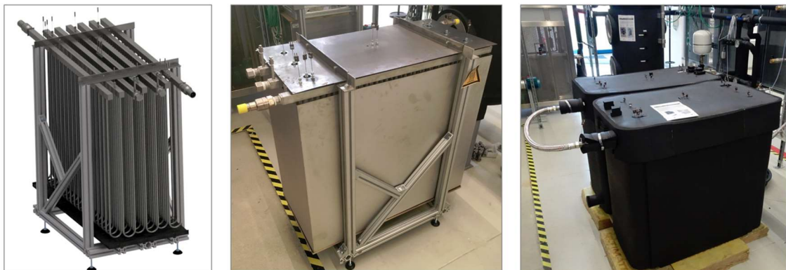
Abb. 2-4 Latentwärmespeicher in Rohrbündel-Bauweise (aus [13]); V.l.n.r.: Rohrbündel und Halterung als CAD-Darstellung, Latentwärmespeicher mit Sensorik (ungedämmt bzw. gedämmt)
