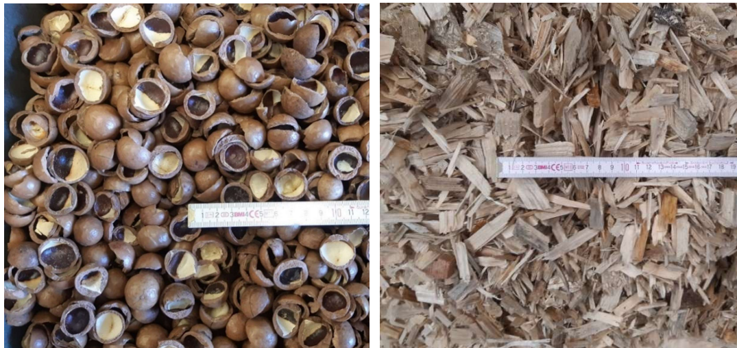
Abb. 2-26 links: Macadamianussschalen, rechts: Standardbrennstoff Nadelholz-Hackschnitzel
