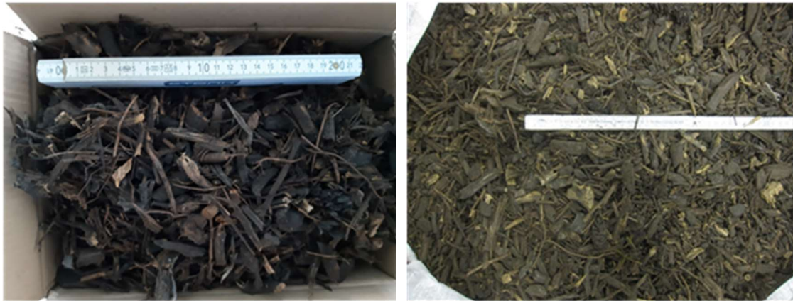
Abb. 2-32 Holziges Material aus dem Siebüberlauf; links: Laborprobe; rechts: Material für Vergasungstest
