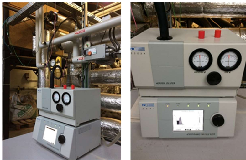
Abb. 2-6 Erfassung der Partikelgrößenverteilung mit dem Particle Sizer 3321 sowie dem Diluter 3302A von TSI
