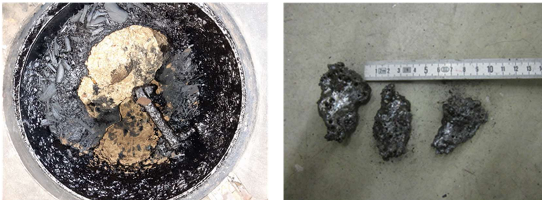
Abb. 2-30 Nach Einsatz der LPM-Presslinge; links: Blick von oben in den Reaktor; rechts: aus dem Reaktor entfernte Schlackebrocken
