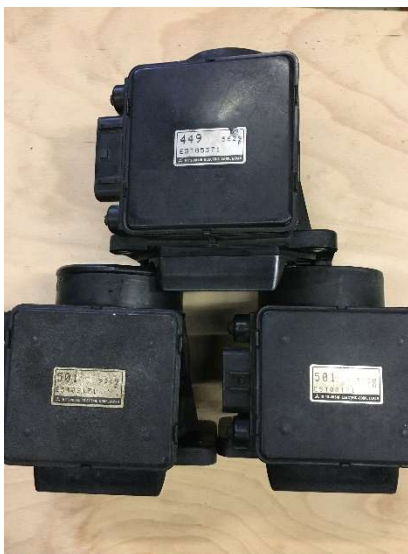
Abb. 2-21 Untersuchte KV-Durchflussmesser (links) und Vergleich der per Wirkdruckverfahren ermittelten Kennlinien aller drei Untersuchungsobjekte (rechts).
