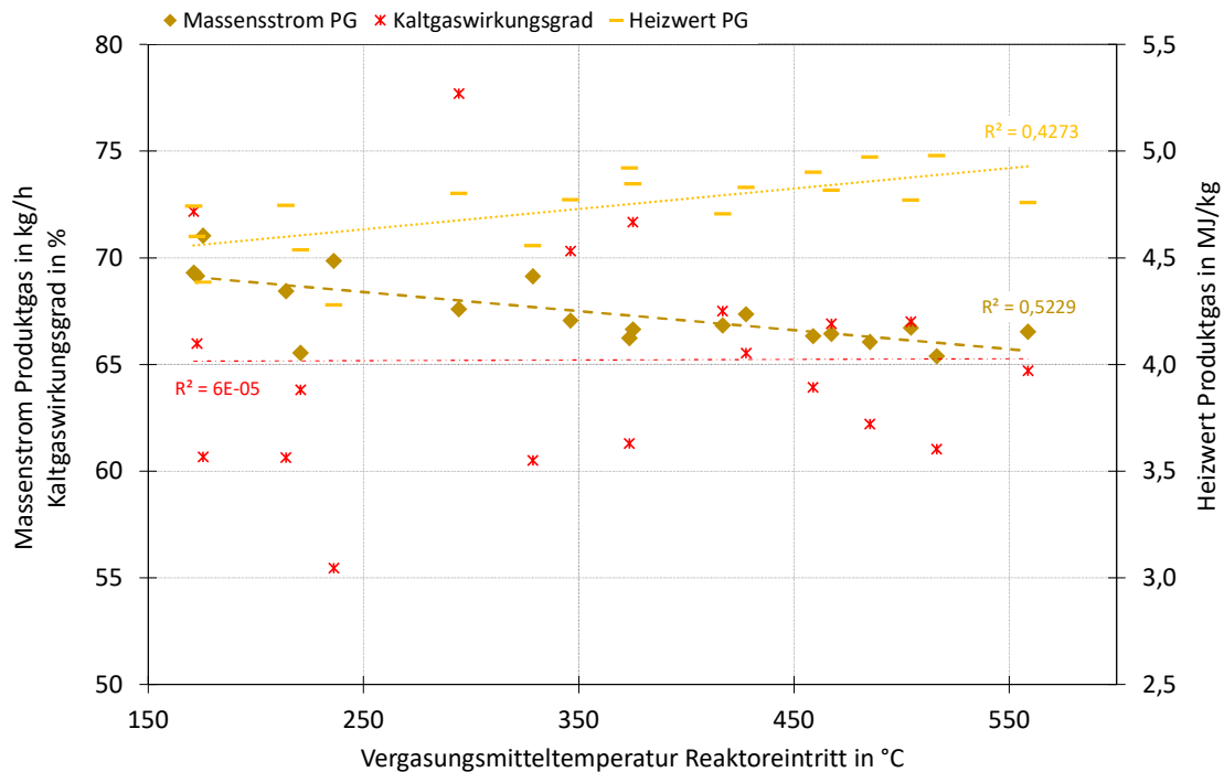
Abb. 2-50 Für Versuchsabschnitt 1 (N = 19 Datenreihen mit Zeitintervall 30 min) ermittelte Bewertungsparameter und -kennzahlen in Abhängigkeit von der Vergasungsmitteltemperatur
