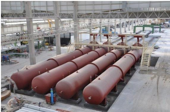
Abbildung 4-2 Autoklaven in einem Betonwerk (Länge ca. 30m)
