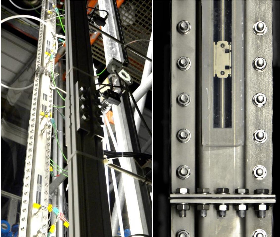
Abb. 4-8 Versuchsstandkomponente CORVUS (links); Edelstahl-Gehäuse mit 3x3-Heizstabkonfiguration in originaler Brennstablänge (rechts)
