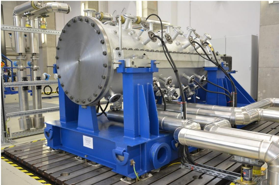
Abb. 4-15 Magnet- und Fanglagerprüfstand MFLP im Zittauer Kraftwerkslabor
