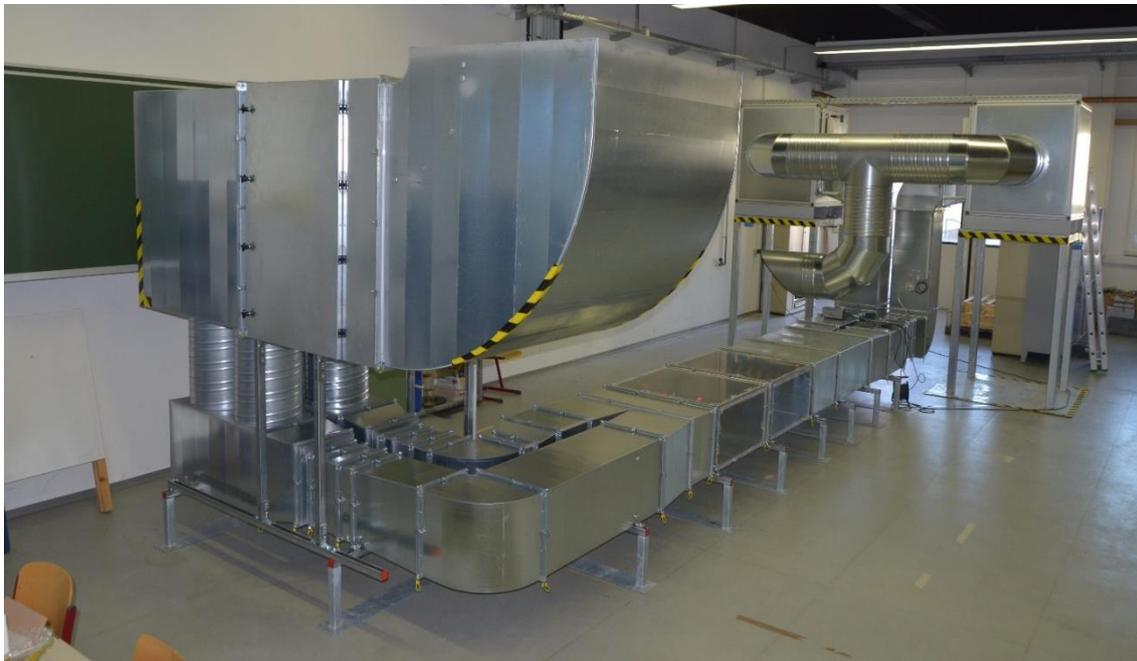
Abbildung 4-6: Versuchsanlage Fortluftkanal
