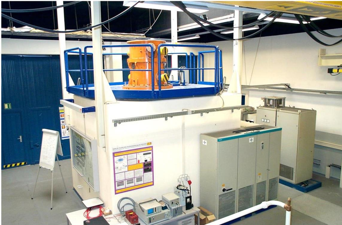
Abb. 4-16 Magnet- und Fanglagerprüfstand FLP 500
