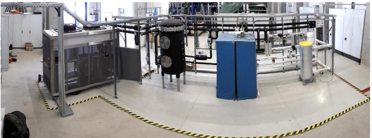
Abb. 4-25 Testfeld für Wärmespeicher
