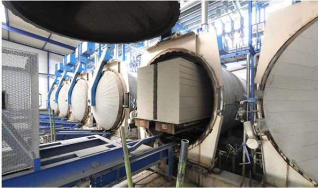
Abbildung 4-1 Autoklav mit geöffneter Tür
