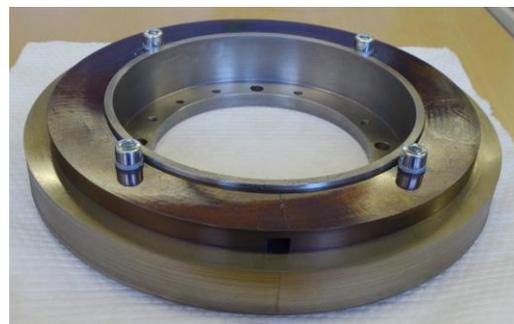
*Abb. 4-12 Stator und Rotor des entwickelten Hochtemperatur-Lagesensors*
