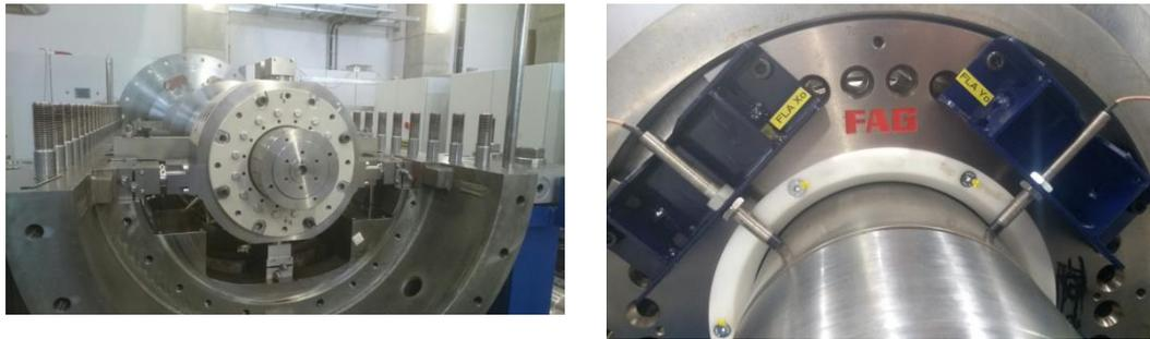
Abb. 4-13 Am MFLP montiertes Gleitfanglager und diversitäres Wellenlagemesssystem für Fanglager-
