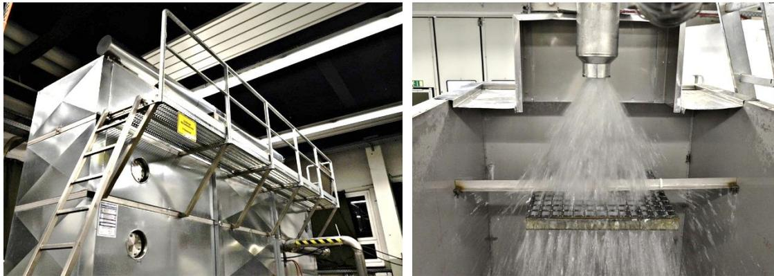
Abb. 4-4 Der Wannenbehälter der Zittauer Strömungswanne (ZSW; links); Korrosionsuntersuchungen an verzinkten Metallteilen in einem simulierten Leckstrahl (rechts)
