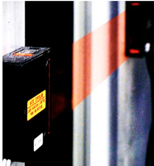
Abb. 4-19 Kompaktes Mehrkammersystem für den Einsatz in Forschung und Industrie (links), Lasersensoren für Trübungsmessung in flüssigen Medien und Objektvermessungen (rechts)
