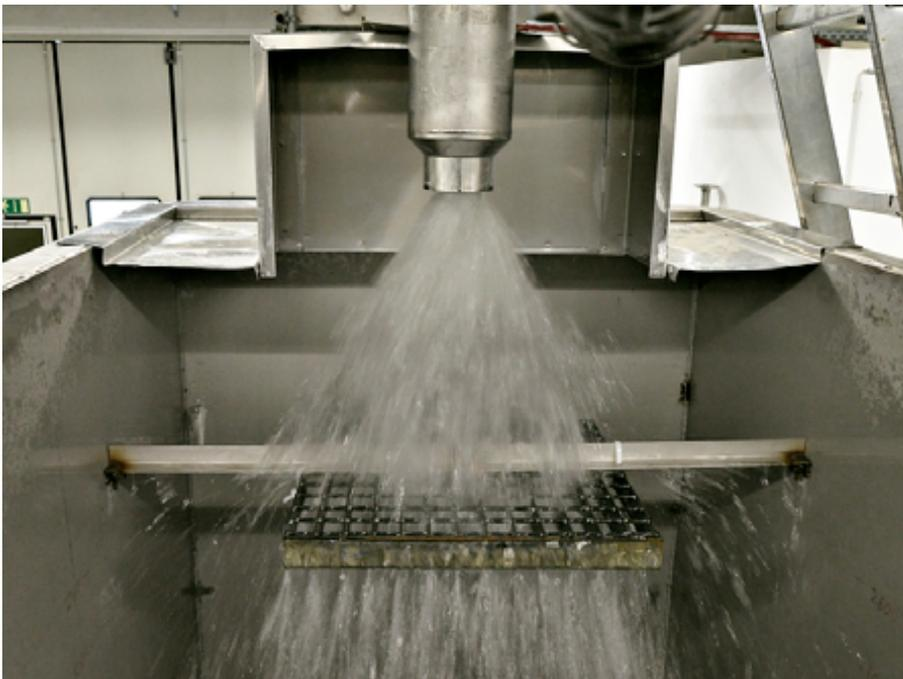
Abb. 4-12 Korrosionsuntersuchungen an verzinkten Metallteilen in einem simulierten Leckstrahl
