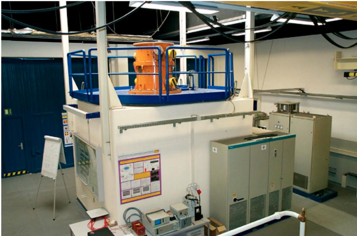
Abb. 4-28 Magnet- und Fanglagerprüfstand FLP 500
