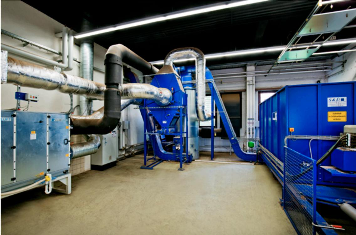
Abb. 4-34 Trocknungsanlage für Holzhackschnitzel
