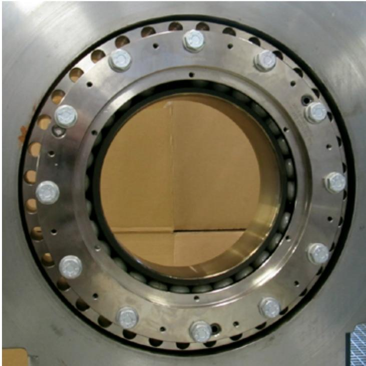
Abb. 4-24 Fanglagereinheit am Versuchsstand MFLP
