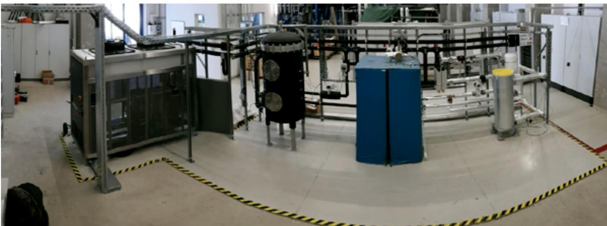
Abb. 4-35 Testfeld für Wärmespeicher
