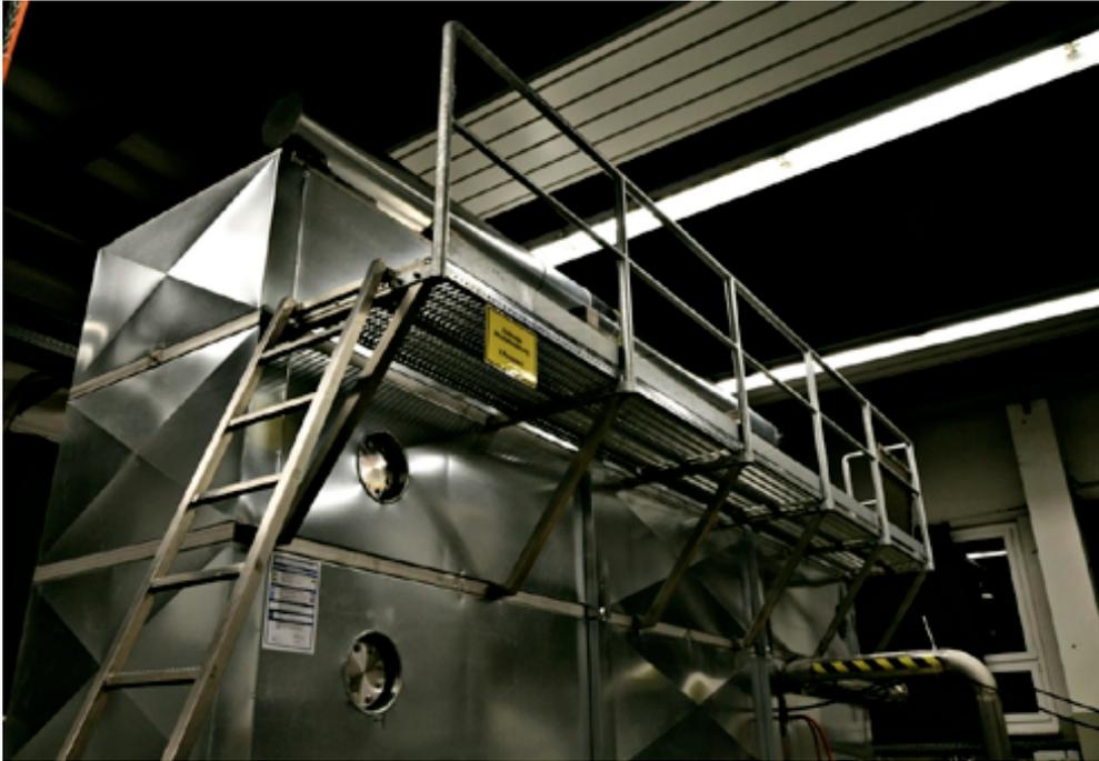
Abb. 4-11 Der Wannenbehälter der Zittauer Strömungswanne (ZSW)
