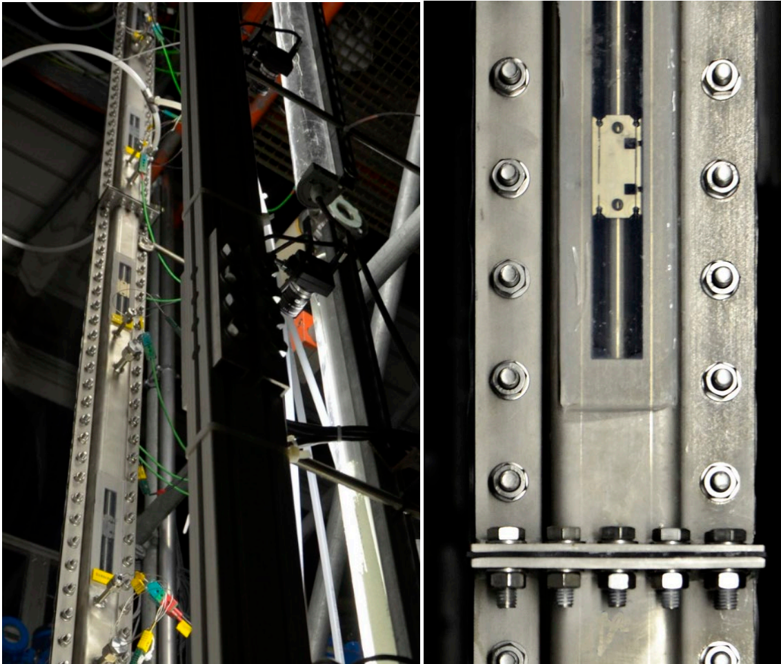
Abbildung 13: Versuchsstandskomponente CORVUS (links); Edelstahl-Gehäuse mit 3x3-Heizstabkonfiguration in originaler Brennstablänge (rechts)
