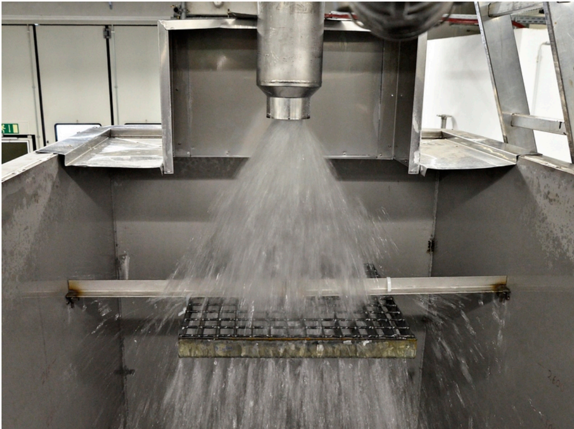
Abbildung 8: Korrosionsuntersuchungen an verzinkten Metallteilen in einem simulierten Leckstrahl
