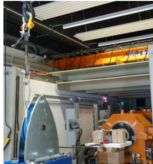
Abbildung 2: Vorrichtung zur rampen- und sprungförmigen Belastung des Axialmagnetlagers
