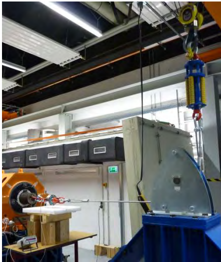
Abbildung 2: Vorrichtung zur rampen- und sprungförmigen Belastung des Axialmagnetlagers
