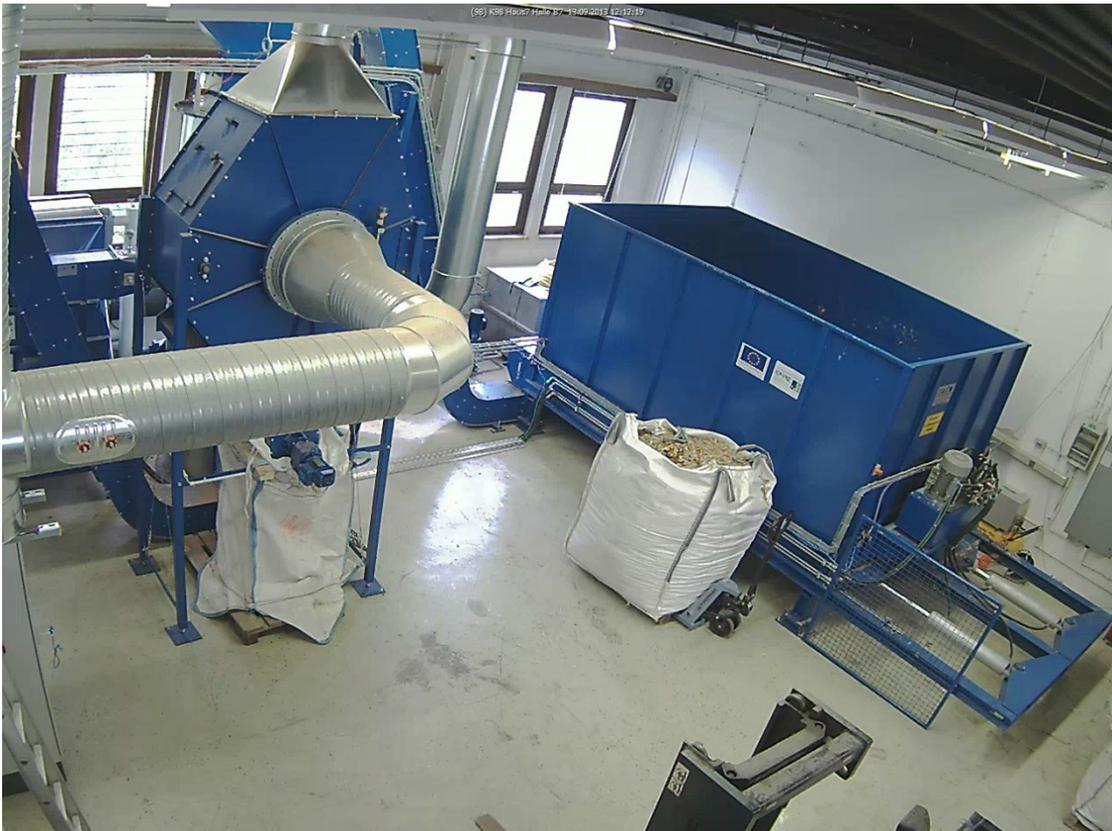
**Abbildung 34: Trocknungsanlage für Holzhackschnitzel**
