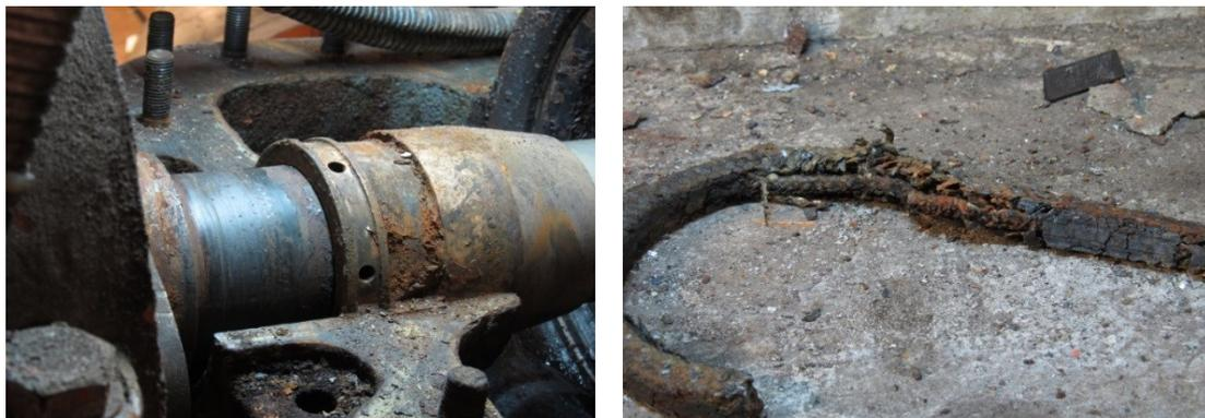
**Abbildung 1: Defekte Keramikbeschichtung im Stopfbuschbereich und zerstörte Lage der Stopfbuchspackung**
