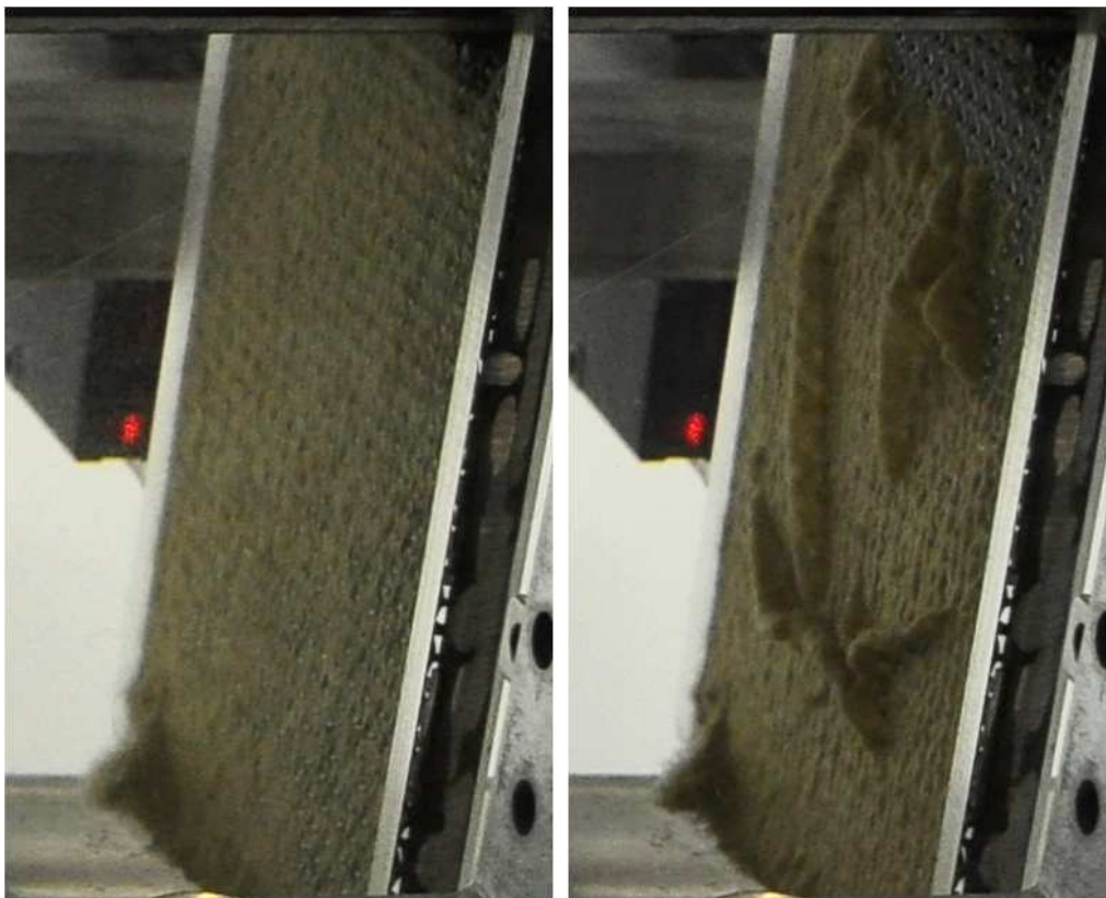
Abbildung 8: Filterkuchen nach einem Anlagerungsvorgang (links) und nach Teilablösung (rechts)
