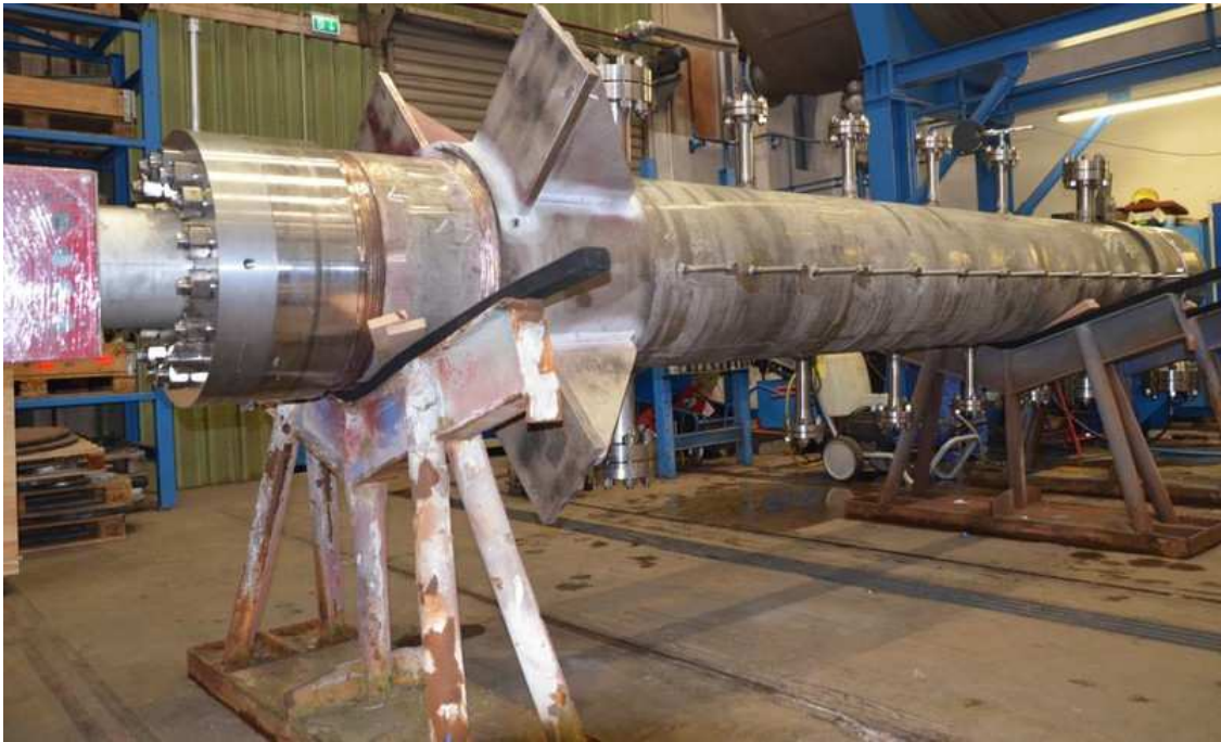
Abbildung 20: Druckbehälter/Dampferzeuger mit Messstutzen im liegenden Zustand während der Druckprobe
