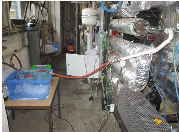
Abbildung 3-9: Produktgasabsaugung und Waschflaschenapparat MS2
