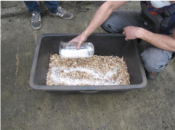
Abbildung 3-2: Zugabe des Katalysators zu den HHS
