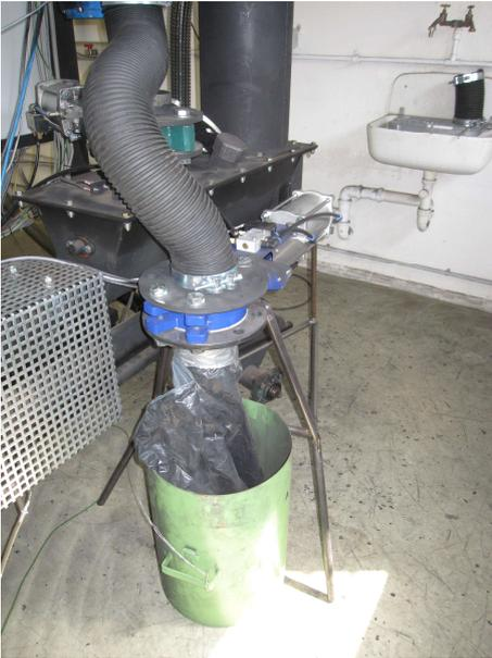
**Abbildung 3-11: Filterstaubaustragsschleuse mit Sammelbehälter**
