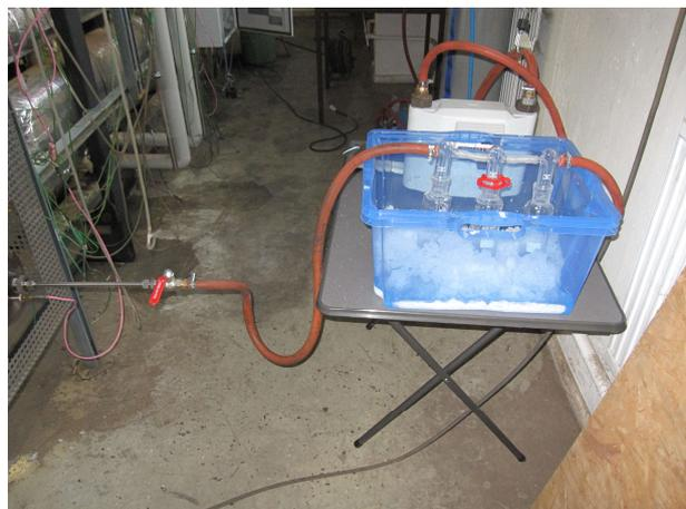
Abbildung 3-10: Produktgasabsaugung und Waschflaschenapparat MS1
