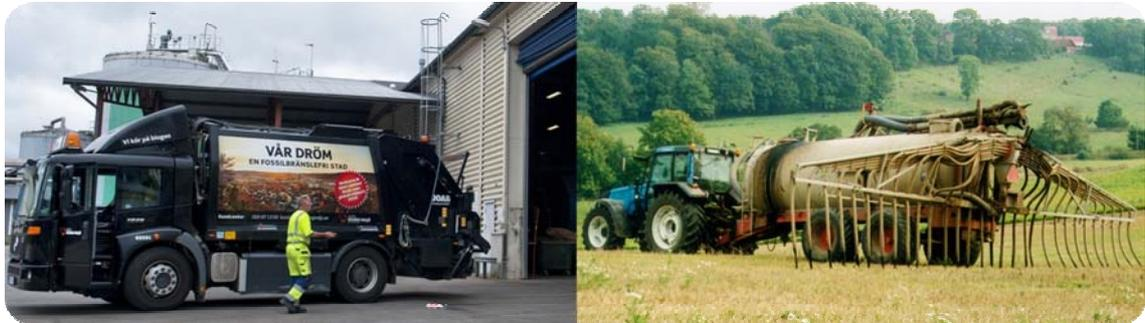
**Abb. 8 Links: SNG-betriebenes Entsorgungsfahrzeug (Bildquelle Borås Energi och Miljö), Rechts: Gärrestausbringung (Bildquelle NSR)**
