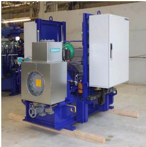
Bild 1: MINI-Turbogenerator Typ SST-040
