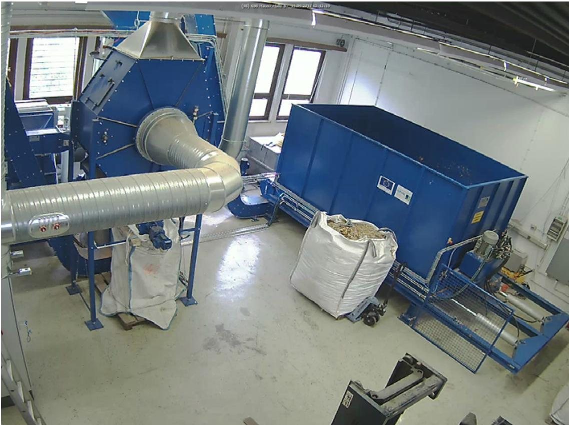
**Abbildung 23: Trocknungsanlage für Holzhackschnitzel**
