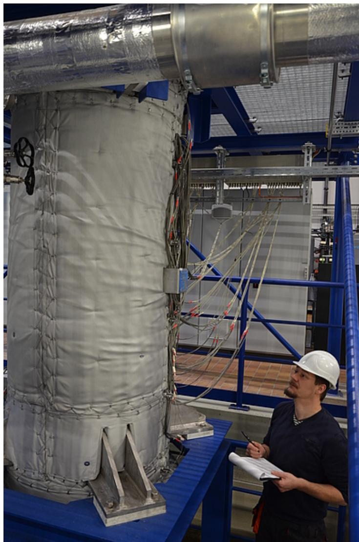
**Abbildung 45:** Herr Braun bei der äußerlichen Kontrolle des Gleichdruckverdrängungsspeichers an der VA THERESA
