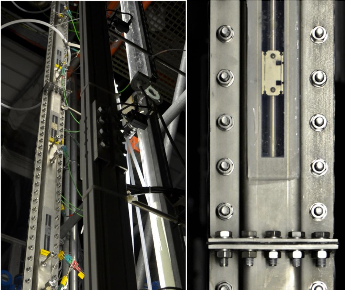
**Abbildung 13:** Versuchskomponente CORVUS (links); Edelstahl-Gehäuse mit 3x3-Heizstabkonfiguration in originaler Brennstablänge (rechts)
