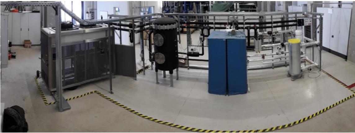
**Abbildung 24: Testfeld für Wärmespeicher**
