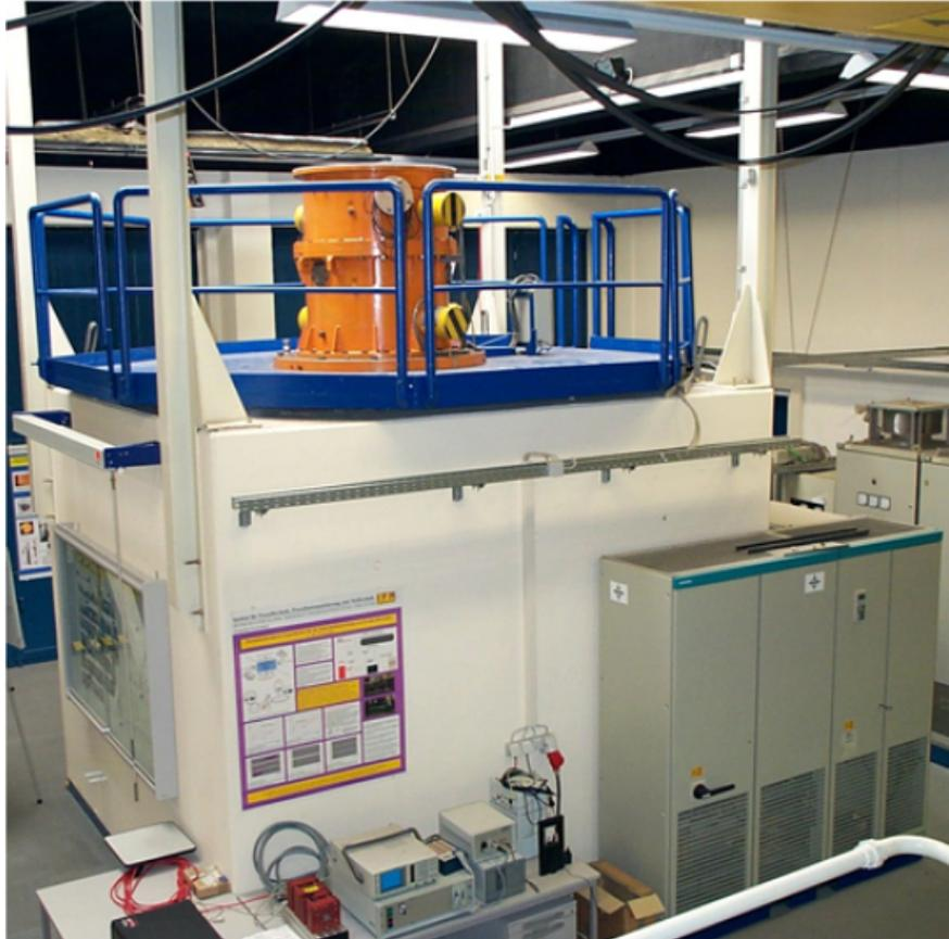
**Abbildung 3: Magnet- und Fanglagerprüfstand FLP 500**
