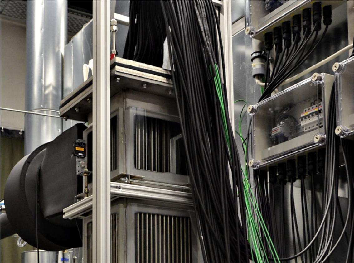
**Abbildung 12: Beheizbarer Brennelemente-Dummy**
