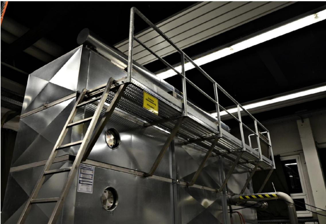
**Abbildung 7:** Der Wannenbehälter der Zittauer Strömungswanne (ZSW)
